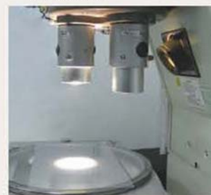
◎ 腹背式對焦方式，對焦過程中，載物台不動，滿足更高精度的要求
