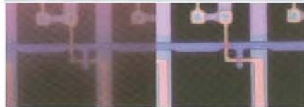
不使用校正 (60倍) 使用0.7mm(60倍)校正
