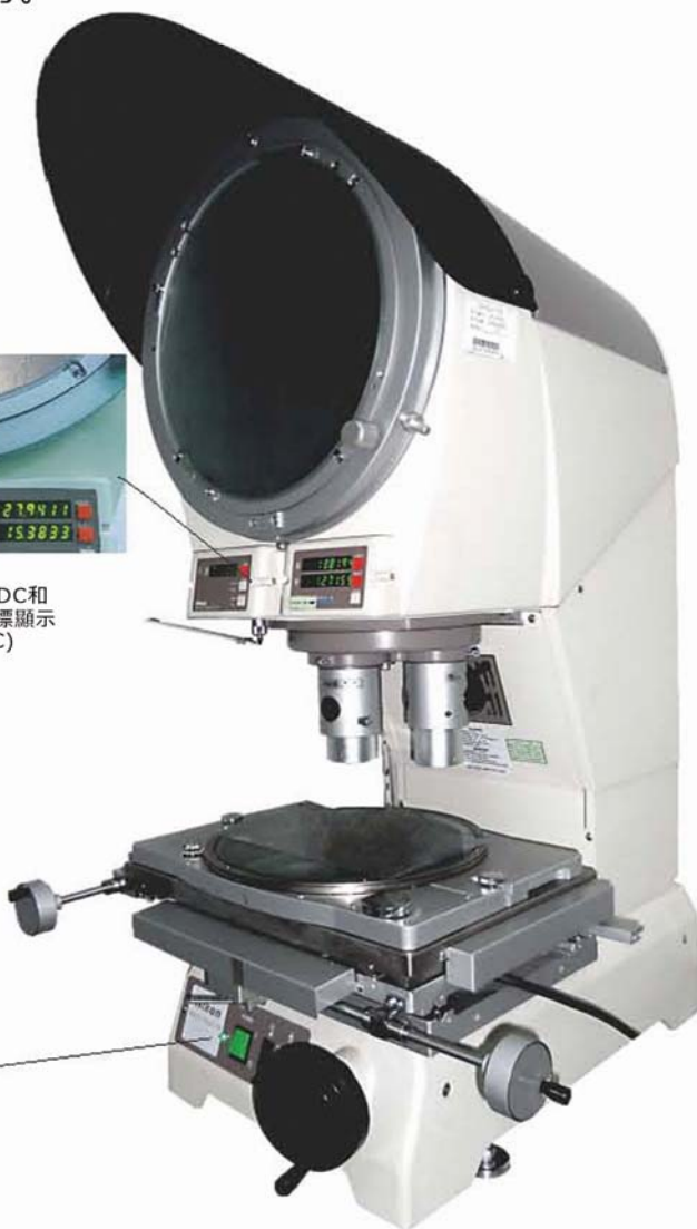
使用8X6載物台、10X、20X、50X鏡頭的配置
