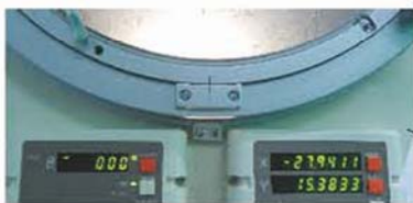
內建角度顯示器(V-12BDC和V-12BD)以及內建XY座標顯示器(V-12BDC和V-12BSC)
