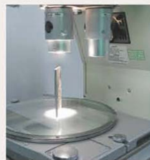
◎ 可接受較高工件的量測，樣本高度可達100mm
