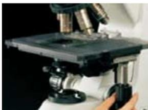
固定式 X,Y 軸調整鈕，不因平台移動 而改變位置
